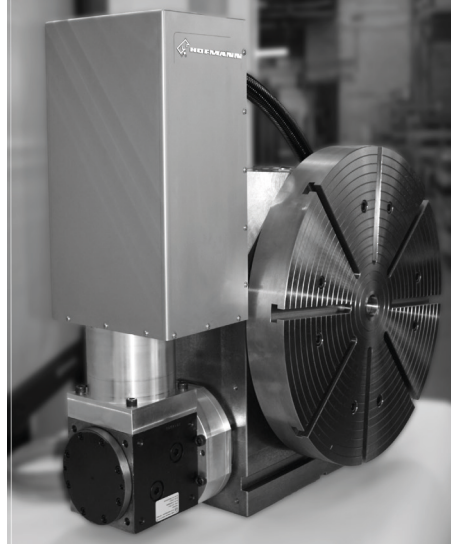
NC-Rundtisch RWNC-300 mit Planscheibe und darunterliegender HSK-Aufnahme
